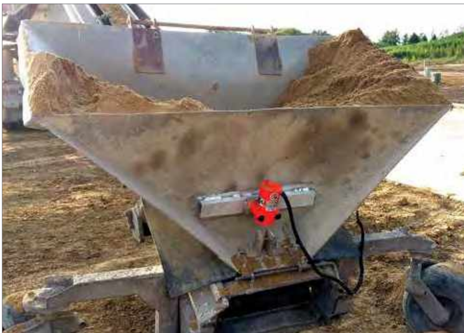
Una tolva de arena fluye sin obstáculos a una cinta transportadora con una sacudida de un vibrador US-450 (ver páginas 46 y 47). Vibco recomienda seguir las instrucciones de sus manuales (incluidos en la caja de cada pedido) para montar el producto de forma correcta o consultar a la fábrica y usar nuestra Virtual Van Visit™, VVV, y montarlo correctamente!
