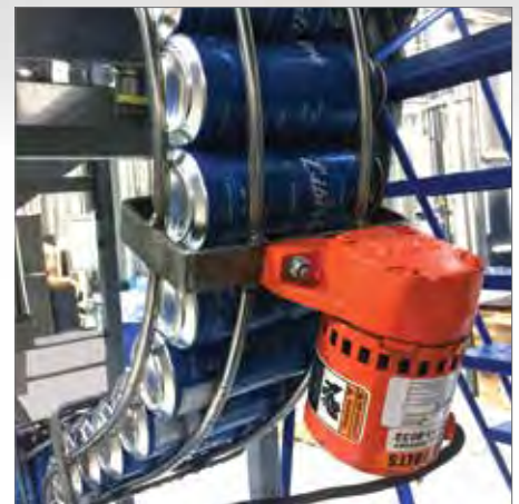
Arriba: Un vibrador modelo SPR mantiene las latas en movimiento sin atascamientos en esta planta embotelladora.
