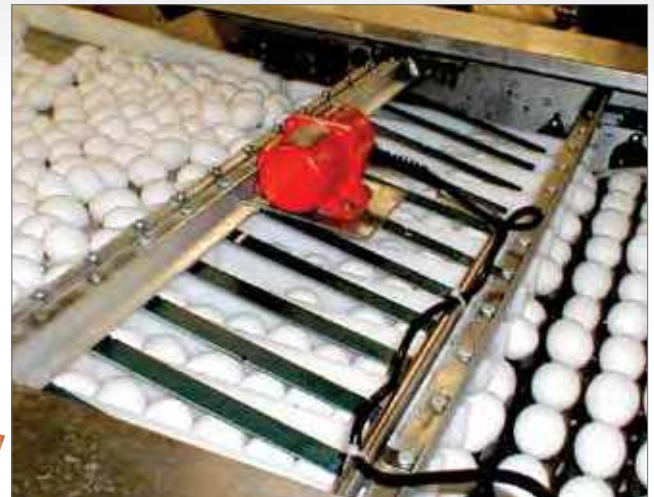
Arriba: Las unidades SCR son ideales para recipientes, conductos, empaque, cribado y mesas de ensayo en condiciones exigentes. Sin embargo, el Modelo SCR-60 también se puede usar con una potencia y frecuencia lo suficientemente delicadas como para separar la clara de la yema sin terminar con huevos revueltos.
