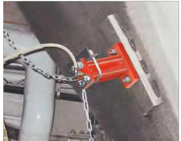
El pistón LI se usa cuando el impacto ajustable se requiere para fracturar puentes de material o canales.
