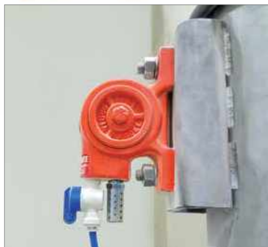
El V-190 de la imagen tiene un silenciador opcional para reducir el ruido. Se coloca una placa de base debajo del canal para obtener más eficiencia.
