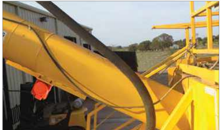
La unidad 2P de la imagen de arriba está sobre una unidad que recupera la arena para que su uso en cualquier aplicación sea seguro para el medio ambiente.
