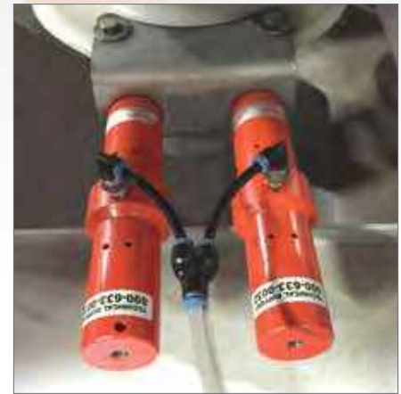
Los vibradores se usan en serie. Todos los vibradores neumáticos de pistón requieren aire lubricado para un funcionamiento adecuado y una larga vida útil. Las unidades como estas 70-1 pueden compartir una línea de aire y seguir funcionando con efectividad.
