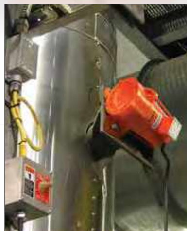
Arriba: El Modelo SFC con soporte para calor (consulte a la fábrica) en la tolva de la imagen es ideal para usar en este ambiente de alta temperatura.
