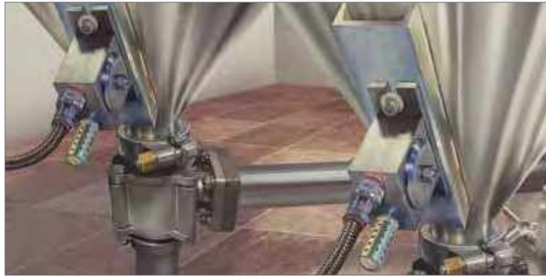
Con cojinetes sellados para alta velocidad que están prelubricados de por vida, los Vibradores MLT (como el MLT-160 de la imagen de arriba) prácticamente no necesitan mantenimiento.
