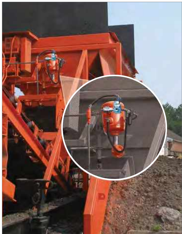
Derecha: Un cañón neumático de VIBCO (páginas 66 y 67), señalado en el círculo blanco, ayuda a mantener un flujo uniforme en la cinta transportadora.
