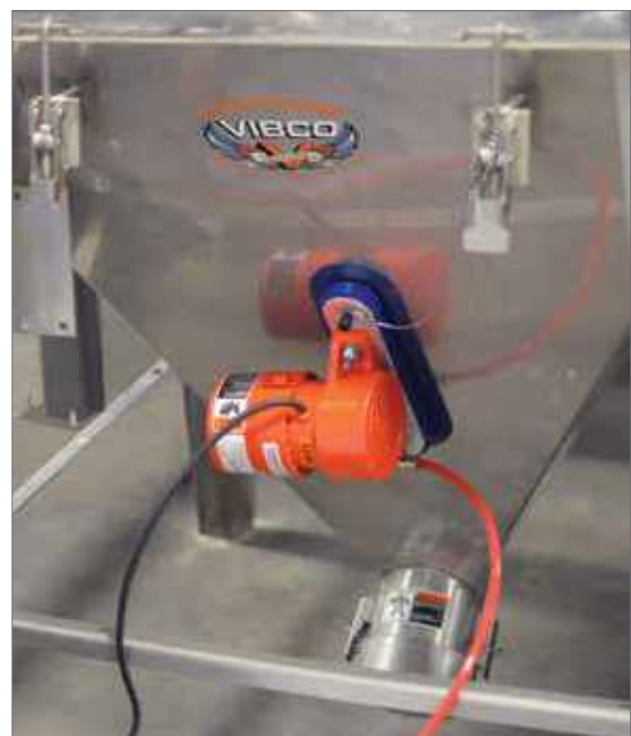
La unidad SPR (páginas 40 y 41) con soporte portátil de vacío Stik-It™ mantiene en movimiento los contenidos de esta tolva con efectividad y limpieza.
